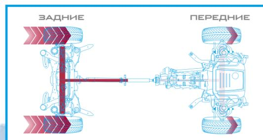
СИСТЕМА ДИНАМИЧЕСКОГО РАСПРЕДЕЛЕНИЯ КРУТЯЩЕГО МОМЕНТА ОТДЕЛЬНО ПОДТОРМАЖИВАЕТ ПЕРЕДНЕЕ И ЗАДНЕЕ ВНУТРЕННИЕ КОЛЕСА.
